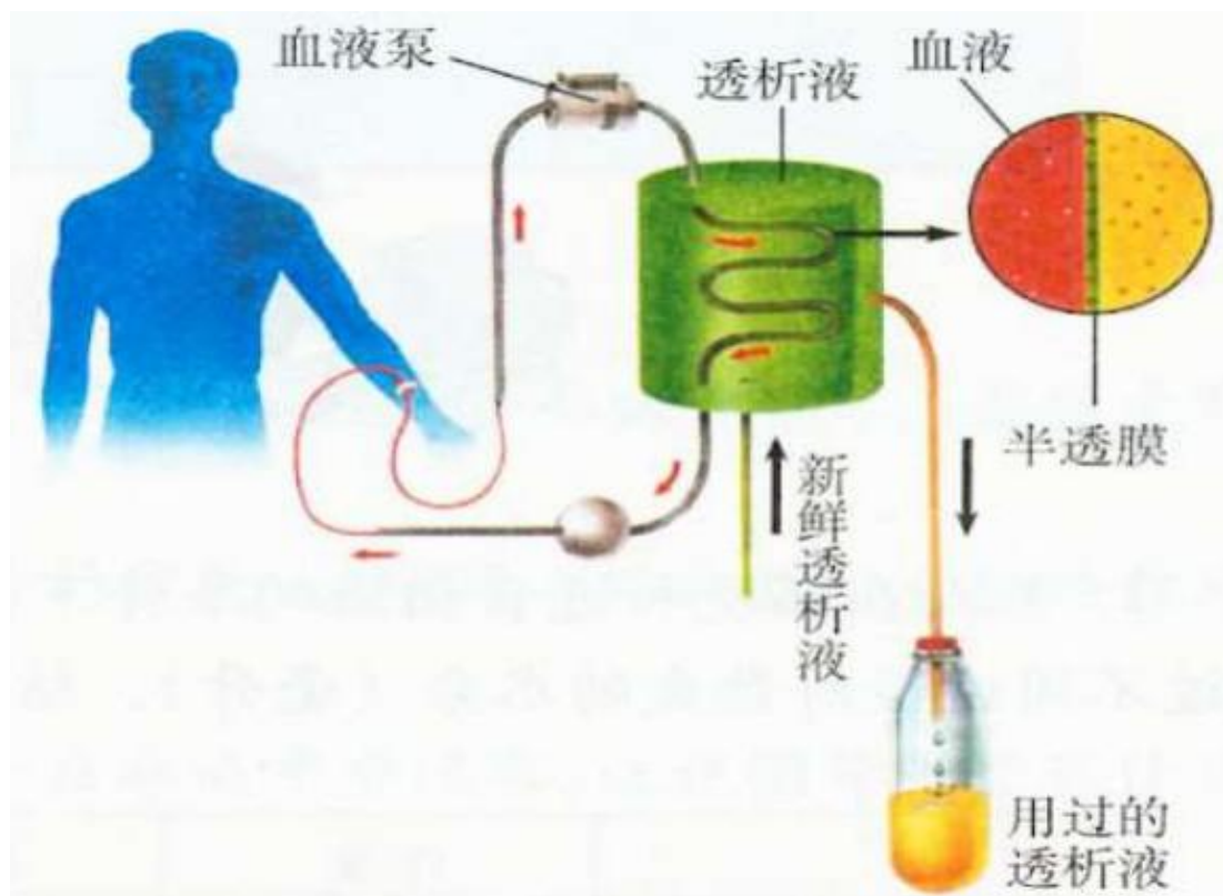
图 2.2-4 血液透析工作原理示意图
