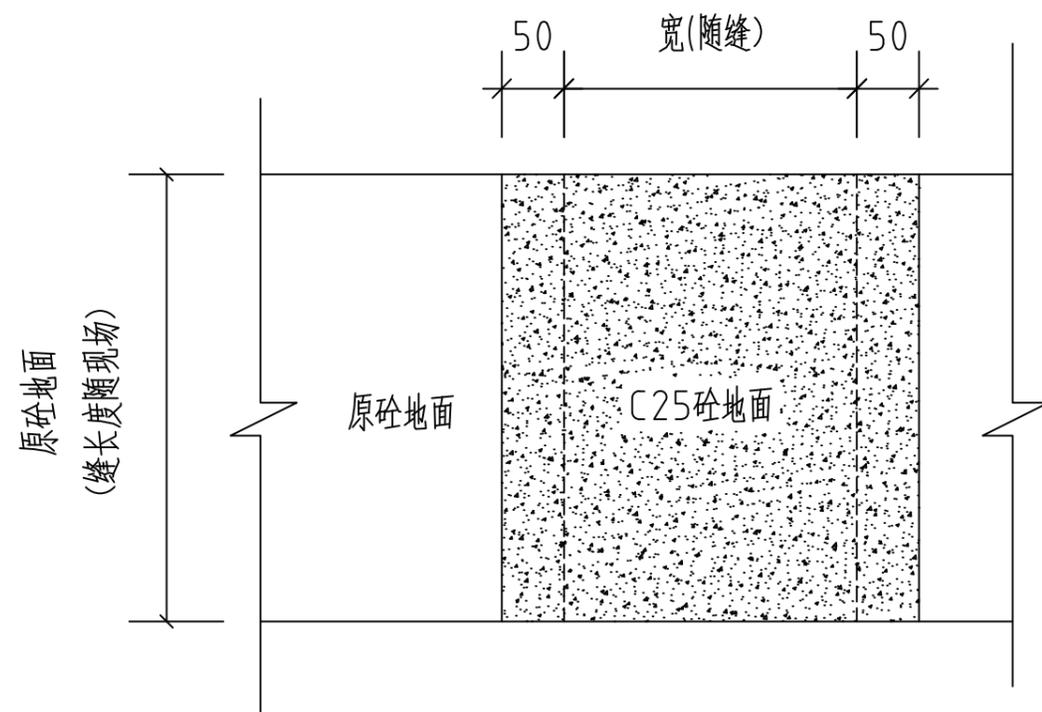
混凝土地面坑洼填补剖面示意图
